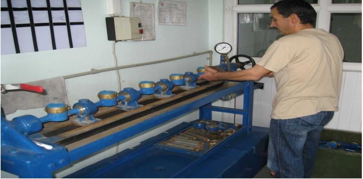
SU SAYAÇLARININ TAMİR EDİLDİKTEN SONRA KONTROL İŞLEMİ
