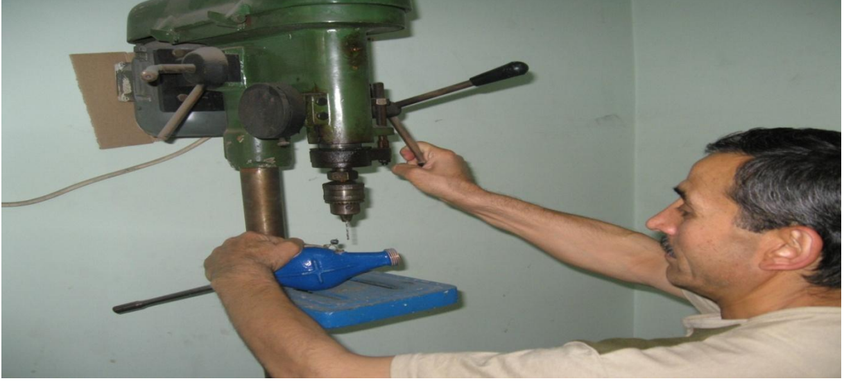
SU SAYAÇLARININ TAMİR İŞLEMİ(SAYAÇ TAMİR-BAKIM İSTASYONU)
