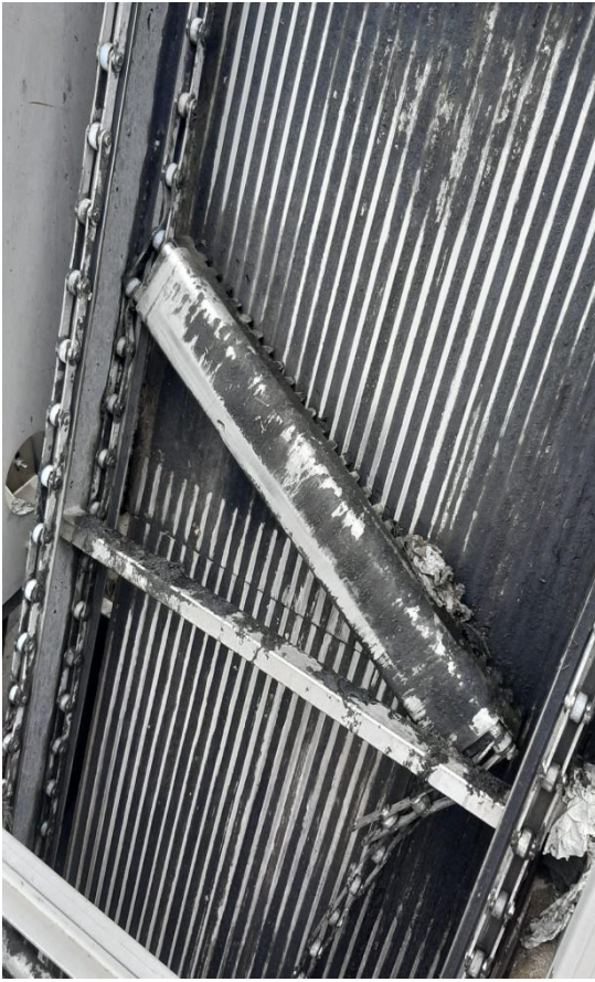
Resim 1: Revizyon Öncesi Arızalı Izgaralar
