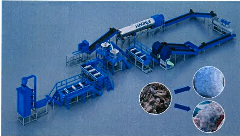
Şekil 10. Örnek termomekanik geri dönüşüm makinesi hattı
